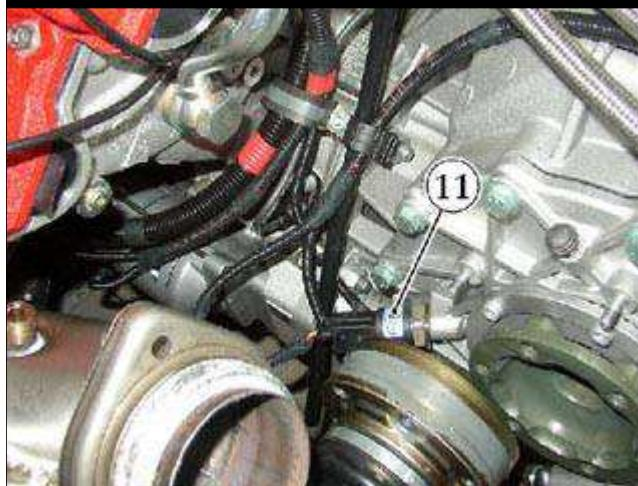
● 断开控制电磁阀 (11) 上的插头。
