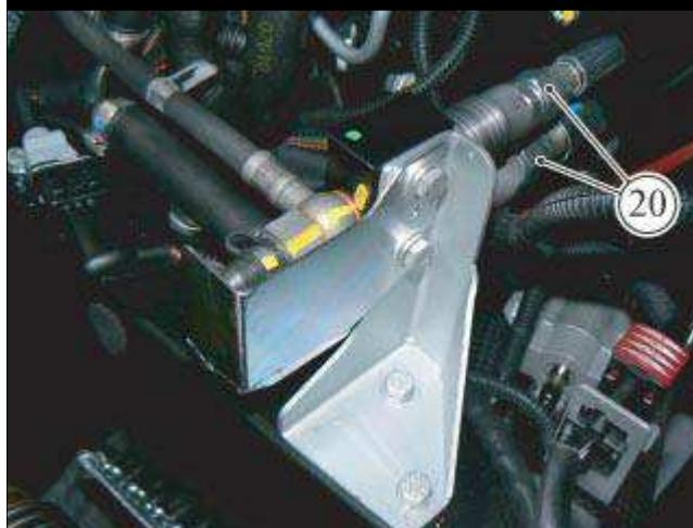
● 在拆卸差速器法兰上的电磁阀和颈部管接头之前，必须从快速管接头分离 E-DIFF 管，以防空气进入动力单元。
